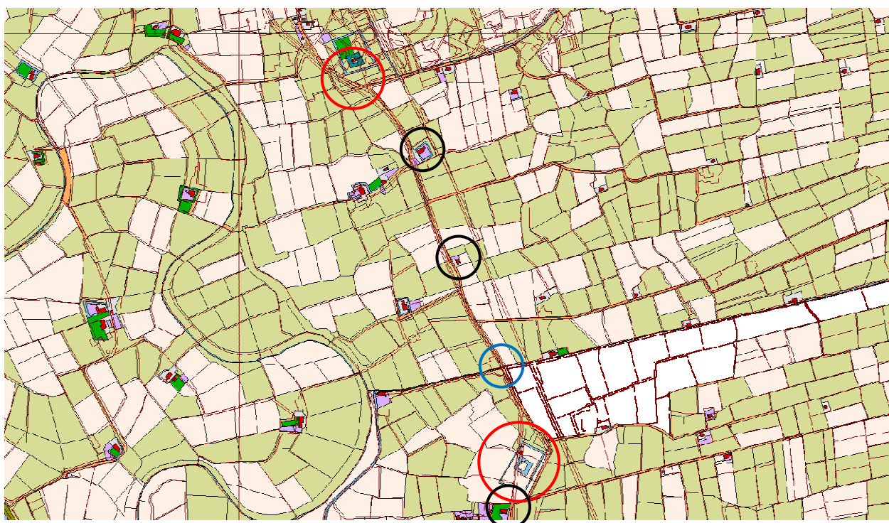
Figuur 2: De kadastrale minuut uit 1828 in gedigitaliseerde vorm met een projectie van de huidige perceelsgrenzen (HisGIS). Het tracédeel van de N361 tussen Winsum (Bellingeweer) en Wetsinge. De elementen gelegen binnen het wegtracé zijn aangegeven met rode cirkels en de elementen grenzend aan het wegtracé met zwarte cirkels. De kruising met het Wetsingermaar is aangegeven met een blauwe cirkel.
